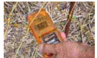
電圧が数字でわかる電圧チェッカーが便利
